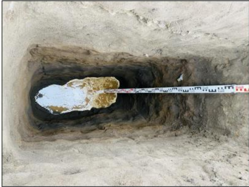
Imagen N° 8: Perfil estratigráfico típico de la zona de estudio (C-01)
